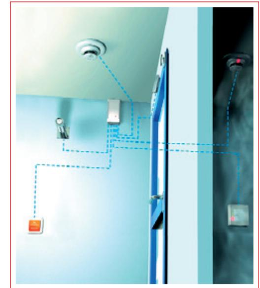
Komponenten / Aufbau einer Feststellanlage
